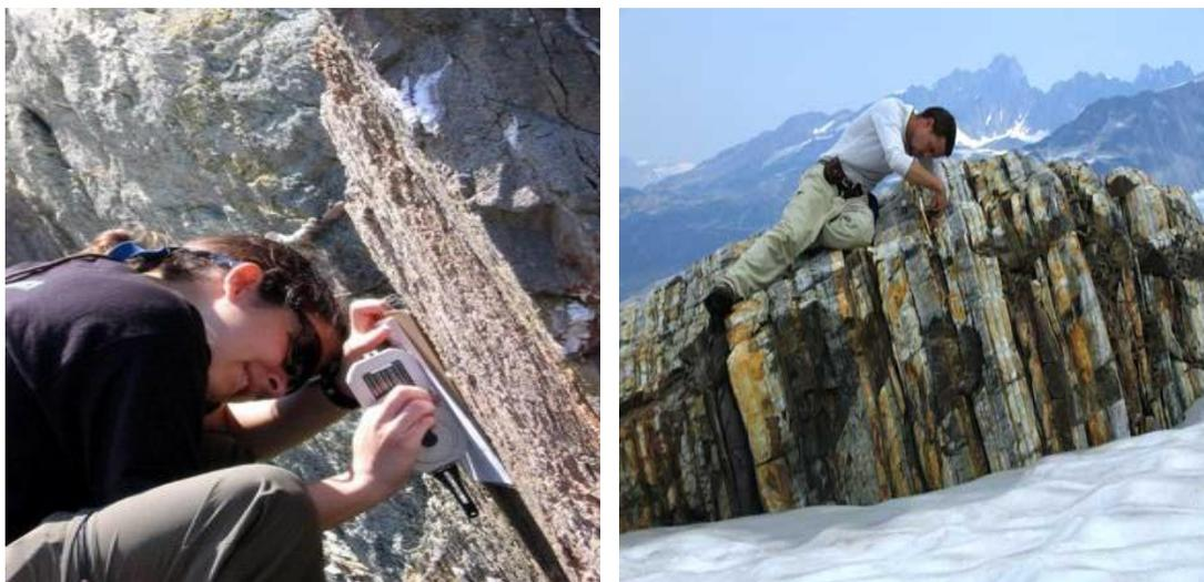
Gambar 12-4 Pengukuran Jurus dan Kemiringan Lapisan Batuan dengan menggunakan kompas
