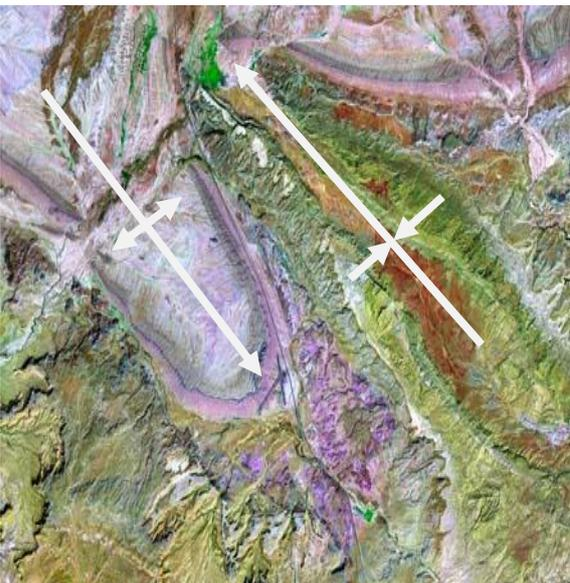
Gambar 6-17. Morfologi lipatan menunjam yang dicirikan oleh bentuk morfologi yang khas yaitu bentuk morfologi sepatu (shoe shape).
