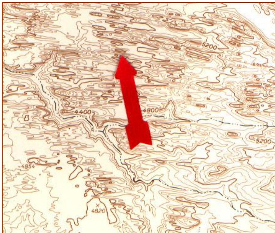
Gambar 5-14 Peta topografi yang memperlihatkan kontrol kekar dan lineament
